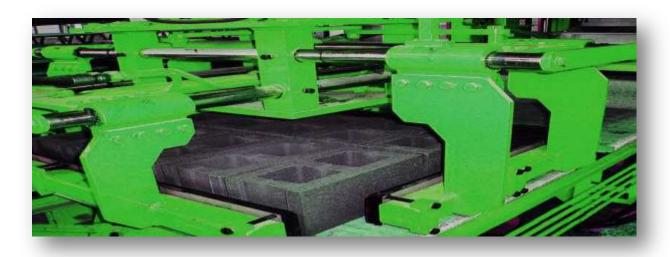
IT IS THE EQUIPMENT THAT STACKS THE DRIED PRODUCTS ON THE EURO PALLET. IT HAS THE CAPABILITY TO TURN AROUND 360°. IS PNEUMATICALLY DRIVEN AND ENSURES ACCURATE PROTECTION AGAINST CONCRETE BLOCK BREAKAGE. UP AND DOWN / RIGHT — LEFT AND GEAR WHEEL ROTATION MOVEMENTS; OPERATING SYSTEM DRIVEN BY SERVO MOTORS WITH REDUCERS. UP AND DOWN 7,5 kw./ RIGHT — LEFT 3 kw. AND GEAR WHEEL ROTATION 1,5 kw. HEIGHT MEASUREMENT MADE VIA LASER METER.
