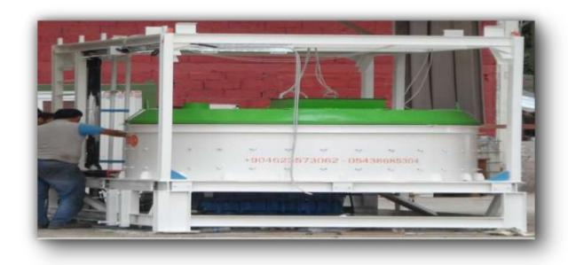
INSTALLATION PLATFORM FOR TWINSHAFT AND PAN TYPE MIXERS. MANUFACTURED USING NPU 120. BESIDES IS A WALKING PLATFORM FOR THE OPERATOR. IS DESIGNED FOR INSTALLATION OF 2 MIXERS.
