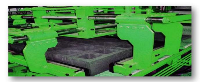
IT IS THE EQUIPMENT THAT STACKS THE DRIED PRODUCTS ON THE EURO PALLET. IT HAS THE CAPABILITY TO TURN AROUND 360°. IS PNEUMATICALLY DRIVEN AND ENSURES ACCURATE PROTECTION AGAINST CONCRETE BLOCK BREAKAGE. UP AND DOWN / RIGHT — LEFT AND GEAR WHEEL ROTATION MOVEMENTS; OPERATING SYSTEM DRIVEN BY SERVO MOTORS WITH REDUCERS. UP AND DOWN 15kw./ RIGHT — LEFT 5,5 kw. AND GEAR WHEEL ROTATION 3 kw. HEIGHT MEASUREMENT MADE VIA LASER METER.
