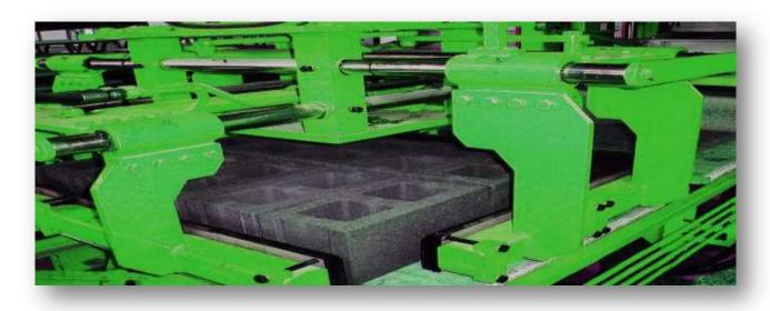
IT IS THE EQUIPMENT THAT STACKS THE DRIED PRODUCTS ON THE EURO PALLET. IT HAS THE CAPABILITY TO TURN AROUND 360°. IS PNEUMATICALLY DRIVEN AND ENSURES ACCURATE PROTECTION AGAINST CONCRETE BLOCK BREAKAGE. UP AND DOWN / RIGHT — LEFT AND GEAR WHEEL ROTATION MOVEMENTS; OPERATING SYSTEM DRIVEN BY SERVO MOTORS WITH REDUCERS. UP AND DOWN 7,5kw./ RIGHT — LEFT 3 kw. AND GEAR WHEEL ROTATION 1,5 kw. HEIGHT MEASUREMENT MADE VIA LASER METER.
