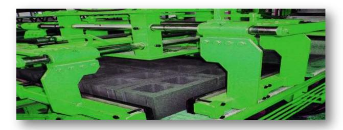
IT IS THE EQUIPMENT THAT STACKS THE DRIED PRODUCTS ON THE EURO PALLET. IT HAS THE CAPABILITY TO TURN AROUND 360°. IS PNEUMATICALLY DRIVEN AND ENSURES ACCURATE PROTECTION AGAINST CONCRETE BLOCK BREAKAGE. UP AND DOWN / RIGHT — LEFT AND GEAR WHEEL ROTATION MOVEMENTS; OPERATING SYSTEM DRIVEN BY SERVO MOTORS WITH REDUCERS. UP AND DOWN 11 kw./ RIGHT — LEFT 4 kw. AND GEAR WHEEL ROTATION 2,2 kw. HEIGHT MEASUREMENT MADE VIA LASER METER.
